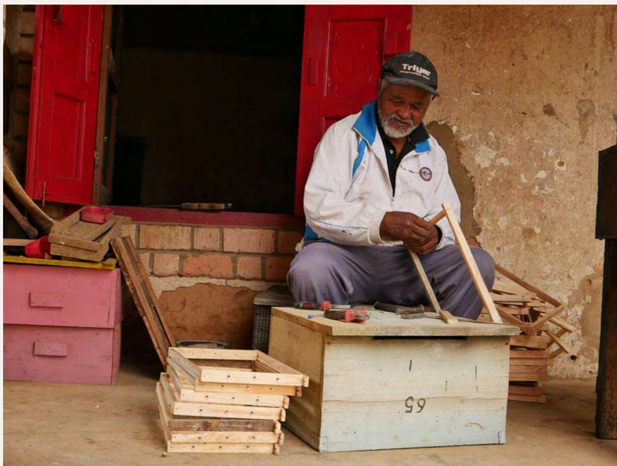
Confection d'un cadre de ruche, élément essentiel pour accueillir les rayons de cire.
