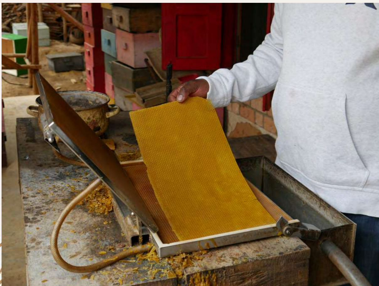
Machine à gaufrer la cire, utilisée pour préparer les feuilles de cire qui guideront les abeilles dans la construction des rayons.
