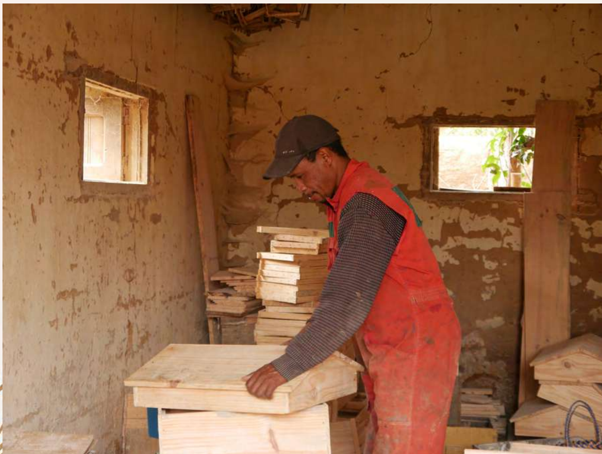
Atelier de fabrication de matériel apicole, chaque outil est conçu localement dans les locaux de Njara.
